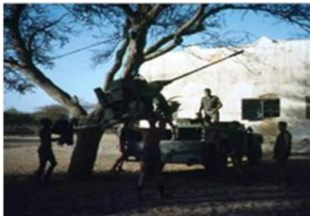
Premier montage canon de 20mm sur VLRA. Le système D légionnaire, faute de grue.
